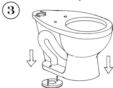
3 Coloque con cuidado la taza del inodoro en la brida del piso mientras se alinean los pernos en "T" a través de 2 orificios en la base de la taza del inodoro.
