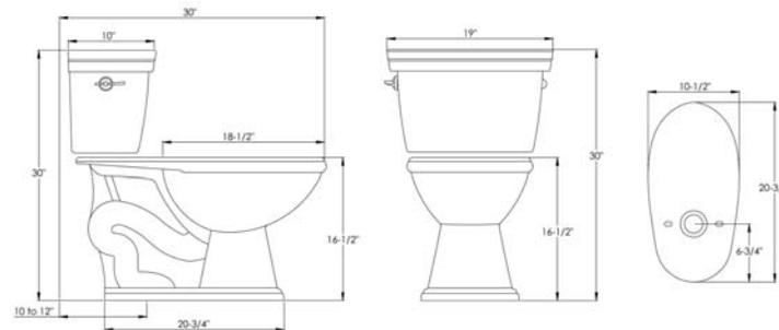
Nota: El diagrama muestra el tanque en una posición aproximada de 10". El tanque se desliza hacia la parte trasera 2" para una posición de 12". El tanque puede ser ajustado en cualquier parte entre 10" a 12".
